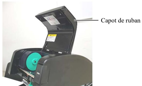
5. Mettez le noyau du rouleau d'alimentation en ruban dans les supports de ruban (côté alimentation) en prenant soin d'aligner l'encoche du noyau du ruban avec la protubérance de la butée du ruban.
